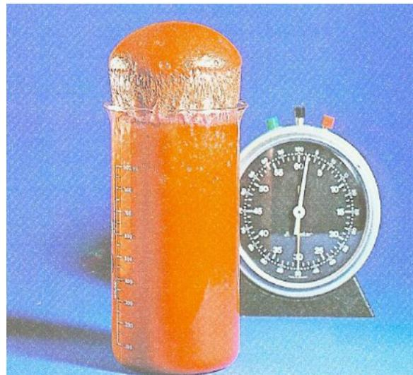
**Verarbeitung** HydroBloc®516 ist ein schnell reagierendes System aus zwei Komponenten. Das Schaumharz wird verarbeitungsfertig geliefert und kann direkt aus den Liefergebinden mit den üblichen 2K-Dosierpumpen verarbeitet werden. Besondere Anforderungen an die Werkstoffe der Maschinen bestehen nicht.
