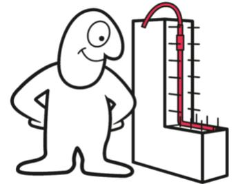
Injektion 402 ist ein Injektionsschlauch für die Abdichtung von Arbeits- und Bauteilfugen im Hoch- und Tunnelbau. Der Schlauch besteht aus hochfestem Gummi mit Millionen von Poren, durch die das Harz in die Fuge und die umgebende Struktur eindringt. Das kosteneffiziente System ist absolut zuverlässig, dank einer speziellen Schutzoberfläche, die vor dem Verschließen durch Zementleim schützt.
