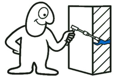
HydroBloc PU 640 ist ein Hochgeschwindigkeitsharz für Klebeverankerungen. Die Verankerung ist durch die 2-Schritt-Reaktion einfach. Die erste Stufe entwickelt sich direkt nach dem Mischen, das Material wird zu einer thixotropen, stabilen Paste mit ausgezeichneter Pumpfähigkeit. Im zweiten Schritt verwandelt sich das Harz in einen sehr harten Polyurethan-Kunststoff mit hervorragender Haftung auf allen Substraten. Die leichte Ausdehnung des Harzes unterstützt die Haftung des Dübels zusätzlich.
