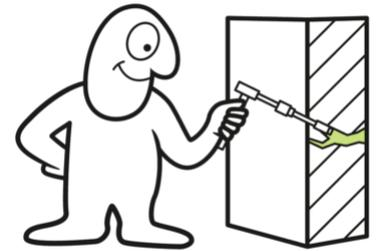
HydroBloc OM-Typen sind Organo-Mineral-Harze - Hybride aus Silikat und PU. HydroBloc OM-Harze eignen sich aufgrund ihrer hervorragenden Stabilität, Dauerhaftigkeit und Haftfähigkeit für Verfestigungs-, Verankerungs- und Stabilisierungsaufgaben sowie zum Stoppen von Wassereintrüben im Tunnelbau und Bergbau. HydroBloc OM 591 ist ein schnell abbindendes, nicht schäumendes Harz mit hoher Festigkeit.
