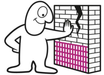
Spiralankermörtel fixiert Spiralanker in gerissenem Mauerwerk. Neben einem hochwertigen Spiralanker ist ein qualitativ hochwertiger Mörtel notwendig, um das Ankersystem richtig zu befestigen und einzubauen. Ein gut abgestimmtes System stabilisiert gerissenes Mauerwerk.
