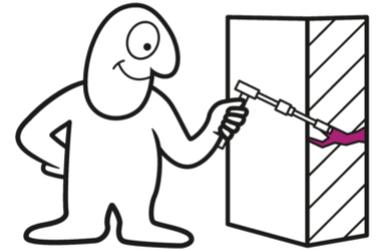
Die Produktlinie Rokryl steht für schnelle Verarbeitung und Harze, die auch unter  $<5^{\circ}\text{C}$  aushärten. Wenn es für Polyurethan- oder Epoxidharze zu kalt ist, sind Rokryl-PMMA-Harze die Lösung. Rokryl-Harze für Injektionen und Verpressungen.
