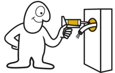
Durchdringungen von Wänden oder Bodenplatten bergen immer das Risiko von Leckagen. Hauseinführungen, Gas, Wasser, Strom, Abwasser, Internet, Fernwärme und Erdwärme dringen in ein Gebäude ein und müssen daher fachgerecht abgedichtet werden.
